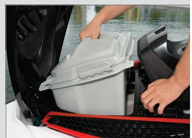
Wasserdichtes, herausnehmbares Staufach
